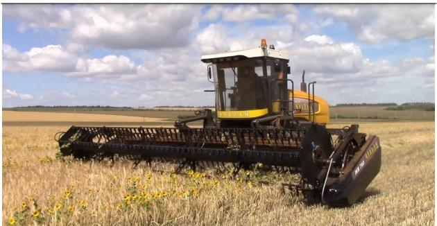
Предназначена для скашивания и укладки в валок зерновых колосовых, зернобобовых и крупяных, а так же кормовых культур раздельным комбайнированием. Косилка может использоваться во всех почвенно-климатических зонах.
